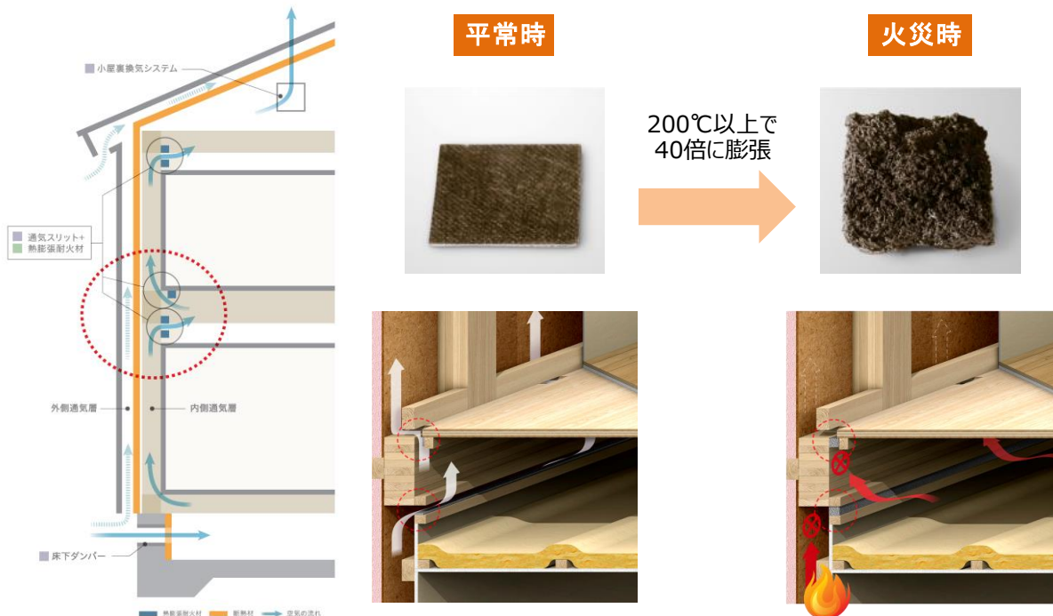
通気経路に熱膨張耐火材を設置し、熱膨張耐火材は200℃以上で40倍に膨張し、通気経路を塞ぐ
